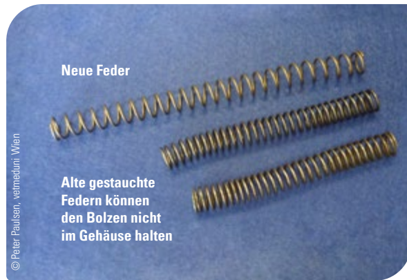
Abb. 8: Gestauchte Federn führen dazu, dass der Bolzen vor der Schussabgabe nicht im Gehäuse versenkt bleibt
