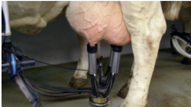
Foto 8: Melkzeug richtig ausgerichtet.
