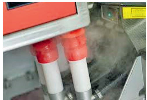
Foto 20: Zwischendesinfektionsanlage mit Heißdampf.
